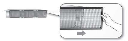
2. Pulire i filtro con un aspirapolvere o con una spazzola a setole morbide. Se la polvere accumulata è eccessiva, sciacquarlo con acqua corrente e asciugarlo in una zona ventilata.
