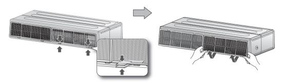
2. Pulire i filtro con un aspirapolvere o con una spazzola a setole morbide. Se la polvere accumulata è eccessiva, sciacquarlo con acqua corrente e asciugarlo in una zona ventilata.
