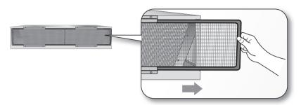
2. Pulire i filtro con un aspirapolvere o con una spazzola a setole morbide. Se la polvere accumulata è eccessiva, sciacquarlo con acqua corrente e asciugarlo in una zona ventilata.
