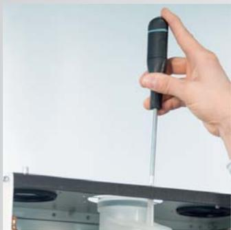
Rimozione vite blocco collettore fumi
