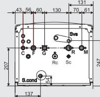
La dima di attacco al muro di KON 28 e 35 è uguale a quella dei modelli minori tranne il disassamento dello scarico fumi di 41,5 mm.
